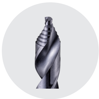
HSSE-Co5 DIN 338, forttec® avec pointe étagée TiAlN et revêtement hélicoïdal
