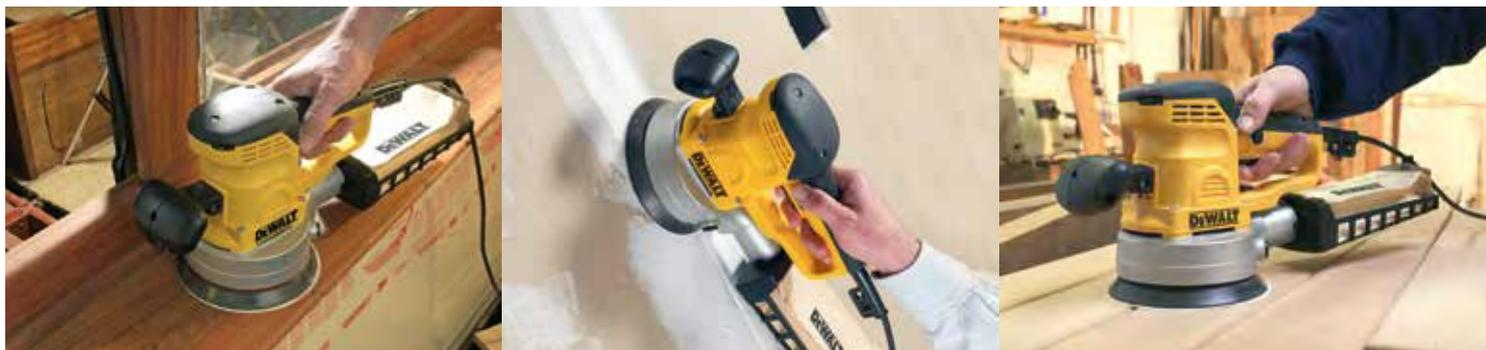
**PONCEUSE EXCENTRIQUE 150 MM**
