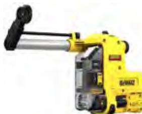
• Système d'extraction des poussières pour DCH283, DCH323, DCH333, DCH334, D25333, D25334 • Jusqu'à 180 mm de profondeur de forage • Pourvue d'un filtre HEPA durable • Nettoyage manuel du filtre avec un bouton spécial • A fixer sans clé sur la machine • Actionnée par le moteur du marteau perforateur • Livrée en boîte carton
