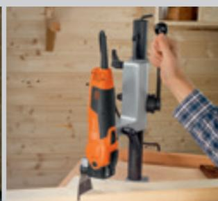
Possibilité d'utilisation avec un support de perçage pour une avance au millimètre près.
