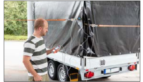
Mesure des forces dans différentes directions de traction ou de compression, possible avec un seul appareil de mesure
