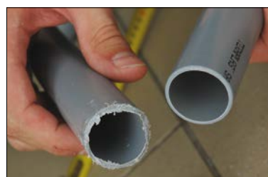
Taglio con un seghetto (sinistra) rispetto al taglio con P-TEC 3240 (destra).
