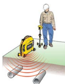
Segnale ad induzione per localizzare i servizi.
