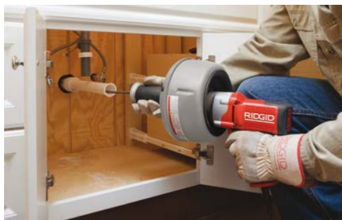
La K-45AF disostruisce rapidamente le condutture intasate. Manda avanti e indietro il cavo senza invertire la rotazione del motore.
