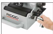
L'accessorio a spazzola opzionale può essere impiegato per una pulizia veloce dei raccordi
