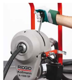
Rilasciare l'impugnatura e il cavo si arresta immediatamente
