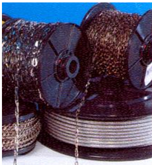
Die Spulen sind einzeln gebremst. Die Ketten können nicht ablaufen.
