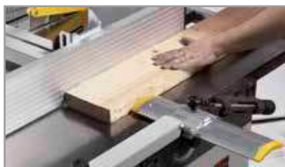
Guida parallela in alluminio per lavori sul piano superiore
