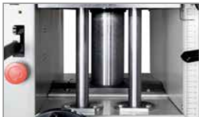
Piano di lavoro per piallatura a spessore montato su 3 guide per evitare basculamenti e rotazioni del piano
