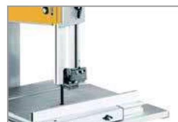
Altezza massima di taglio fino a 170 mm Hauteur max de coupe jusqu'à 170 mm
