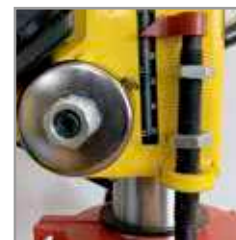
Asta graduata per la regolazione della profondità di foratura Tige graduée pour réglage de la profondeur de perçage
