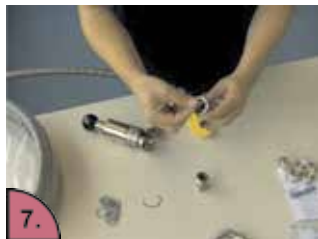
7. Dichtung einlegen . . . Monter le joint . . .
