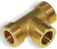
T-Stück Aussengewinde zyl. , dreiseitig extra flachdichtend, Ms58 / CW 617 (CuZn40Pb2) Té égal, 3x Surface d'étanchéité extra large - Cyl. Mâle, Ms58 / CW 617 (CuZn40Pb2)
