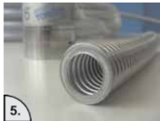
5. Kontrolle der Dichtfläche . . . Contrôler la surface d'étanchéité . . .
