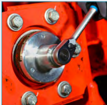
Manœuvre via un cliquet grâce au logement 12,5 mm (1/2") 4 pans
