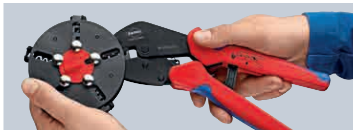
Changement du profil de sertissage : déverrouiller la position du magasin, extraire le profil de la pince
