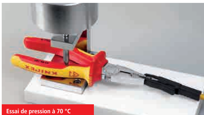
Vérification de l'adhérence des enveloppes VDE avec 500 N à 70 °C
