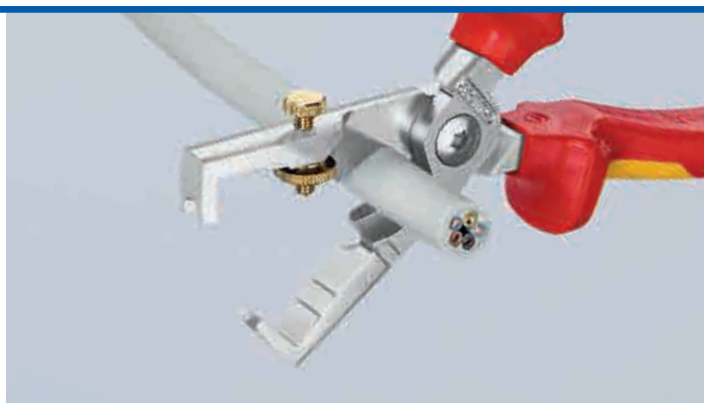
Cisaille trempée par induction avec affûtage de précision pour la coupe sans coincement de câbles Cu et Al jusqu'à Ø 15 mm (5 x 2,5 mm²)
