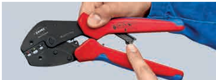
Replier le levier et refermer la pince : prêt pour sa prochaine utilisation
