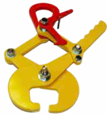
Pince PR pour rails (EN 13155) Cette pince est conçue pour le levage de rails de type Vignoles de 15 à 30 kg/m et jusqu'à 36 à 60 kg/r Elle est dotée d'un système de verrouillage de la position ouverte permettant de déposer la charge sans intervention manuelle. Utilisation par paire avec palonnier recommandé.
