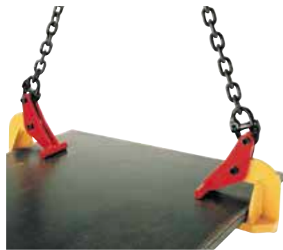
Pince à tôle TLH (EN 13155) Pince pour levage de plaques horizontales. Prise réglable. Employer par paire. Peut être utilisée à un angle de minimum 22,5° à 30°. Sur demande avec prise de 0 - 120 mm et 0 - 150 mm
