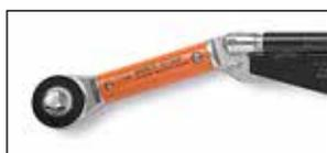
Le mécanisme à cassure avertit l'opérateur que le couple réglé est atteint lorsque le point d'articulation de la clé se plie d'environ 20°.
