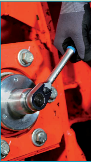
Manœuvre à l'aide d'un cliquet grâce au logement 12,5 mm (1/2") 4 pans
