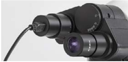
Caméra oculaire oculaire fixé au tube oculaire
