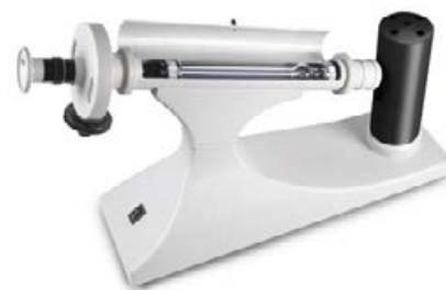
Cuvette dans la chambre de mesure
