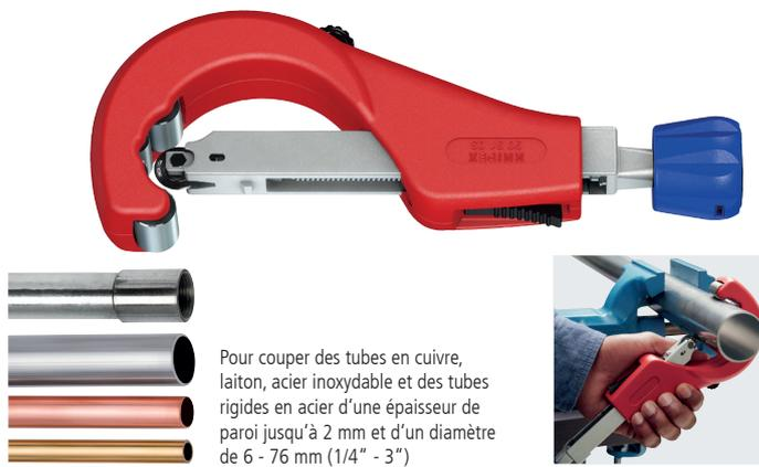
Pour couper des tubes en cuivre, laiton, acier inoxydable et des tubes rigides en acier d'une épaisseur de paroi jusqu'à 2 mm et d'un diamètre de 6 - 76 mm (1/4" - 3")
