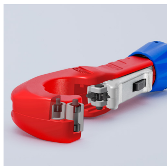
Des roulements à aiguilles de haute qualité permettent à la molette de coupe et aux quatre rouleaux de guidage de fonctionner pratiquement sans frottement gênant pendant la coupe – coupez les tubes en acier inoxydable avec une facilité extraordinaire
