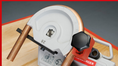
Segments en alu forgé avec affichage de l'angle
