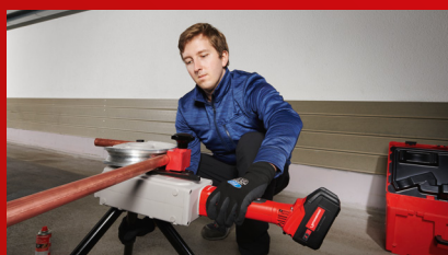
Segments en alu forgé avec affichage de l'angle
