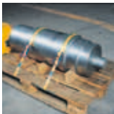
Art. AK 10 25 mm de large, jaune avec tendeur à cliquet bleu et 2 crochets mousqueton, LC 500/1000 daN
